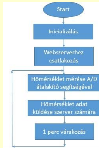
4. ábra Hőmérsékletmérő és adattovábbító alkalmazás működésének folyamatábrája
