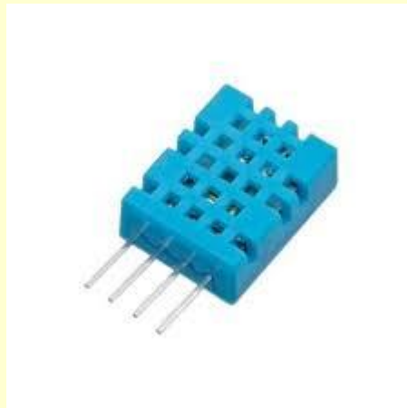
6. ábra DHT11 páratartalom és hőmérséklet érzékelő
