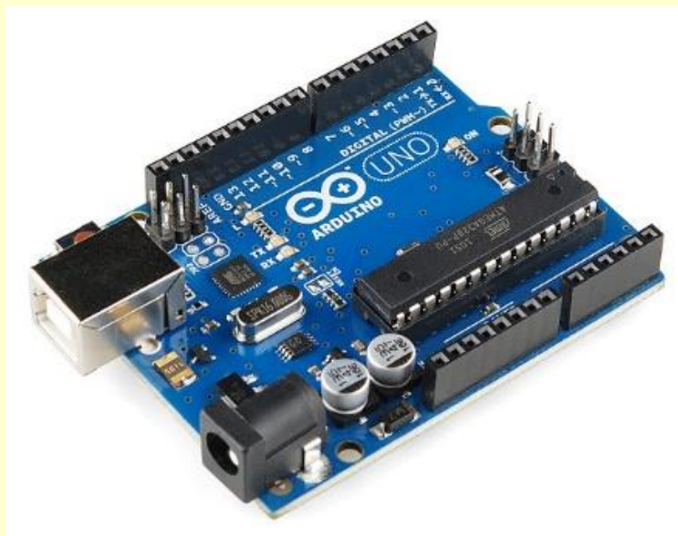
1. ábra Arduino UNO R3
